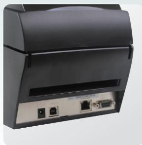
Die integrierten Schnittstellen wie serielle, USB und Ethernet gehören zum Standard ebenso wie die kostenlose Etiketten-Design-Software GoLabel.
