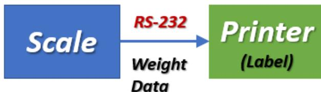
勾選【啟動磅秤列印】這個功能時，電腦必須同時連接磅秤與印表機。在此應用中，標籤檔不需要先下載到印表機，當電腦收到磅秤傳送的重量資訊時，先由程式解析磅秤資料，再對印表機列印，
