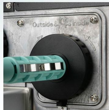
專利碳帶內外捲自動切換設計 安裝方便、使用簡單
