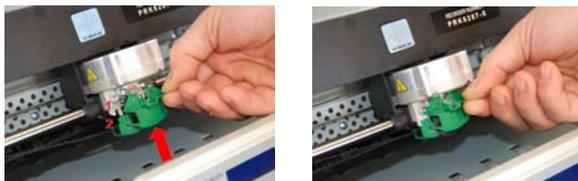
6) Drehen Sie den Einstellknopf in Pfeilrichtung, um die Farbbandspannung zu erhöhen.
