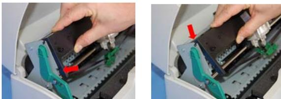
5) Setzen Sie die grüne Farbbandmaske aus Plastik auf den Druckkopf. Vergewissern Sie sich, dass die Stifte (2) an beiden Seiten der grünen Farbbandmaske an den seitlichen Einkerbungen (1) am Druckkopf ausgerichtet sind. Drücken Sie die grüne Farbbandmaske nach oben, bis sie hörbar einrastet.
