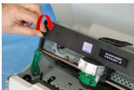
Führen Sie Schritt 3 in umgekehrter Richtung aus: Ziehen Sie den grünen Hebel vorsichtig nach unten, um den Druckmechanismus fest zu schließen. Bitte beachten Sie: Bei nicht geschlossenem Druckmechanismus arbeitet der Drucker nicht ordnungsgemäß. Schließen Sie den Gehäusedeckel.
