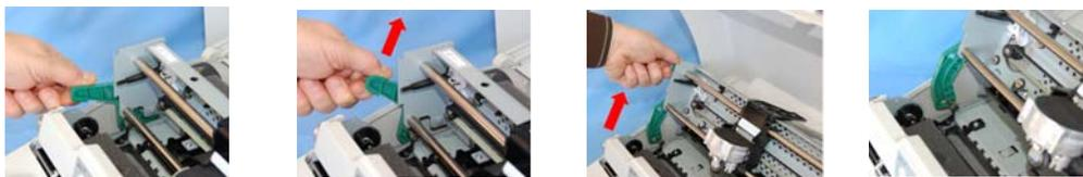
3) Drehen Sie den Einstellknopf in Pfeilrichtung, um die Farbbandspannung zu erhöhen.
