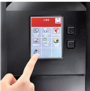
Pantalla táctil en color de 3,2 pulgadas, para una configuración rápida e intuitiva.
