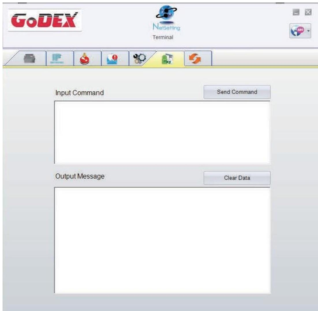
按下“Send Command”鍵可以將印表機命令經由網路傳送到印表機，藉此實現遠端操作功能。
